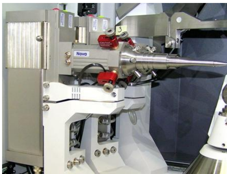
Rysunek 12 Źródło promieni rentgenowskich Nova zamontowane na dyfraktometrze SuperNova
