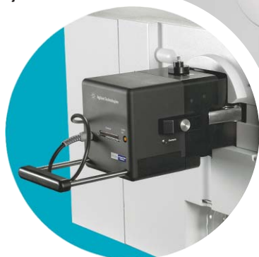
Fuente Electrospray más fiable gracias a la nebulización ortogonal y al gas de secado de alta capacidad para contraflujo
