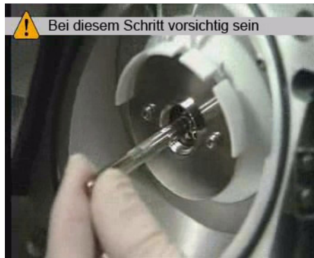
Abbildung 37 Herausziehen der Kapillare aus der Desolvatisierungseinheit
