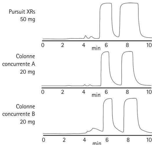
Dimensions: 250 x 4,6 mm, 10 µm, Phase mobile: CH<sub>3</sub>OH : H<sub>2</sub>O / 70 : 30, Débit: 1,0 mL/min, Temp.: 30 °C, Détection: UV @ 254 nm, Échantillon: 1. Benzoate de méthyle, 2. Benzoate d'éthyle
