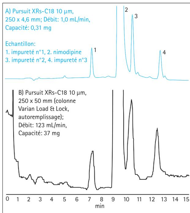
Phase mobile: A: H<sub>2</sub>O + 0,1% TFA, B: CH<sub>3</sub>CN + 0,1% TFA, Gradient: 50-90% B en 10 min, maintien à 90% B pendant 5 min, Temp.: ambiante, Détection: UV @ 254 nm
