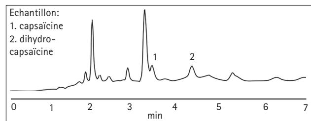
Colonne: Pursuit XRs-C18 10 µm, 250 x 4,6 mm, Phase mobile: CH<sub>3</sub>CN : H<sub>2</sub>O - 70 : 30, Débit: 1,0 mL/min, Temp.: ambiante, Détection: UV @ 220 nm
