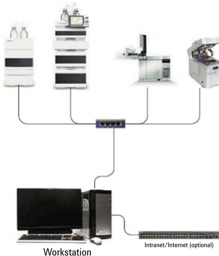
**Abbildung 1** Beispielkonfiguration für die Workstation-Hardware
