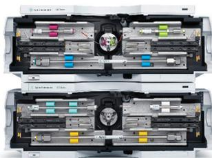
Mit zwei thermostatisierten Säulenöfen und Auswahlventilen, können Sie bis zu acht Säulen von maximal 100 mm Länge oder sechs Säulen mit einem Abfallanschluss und einem Bypass verbinden. Ein dritter Säulenofen ermöglicht die Verwendung von Säulen, die länger als 100 mm sind.
