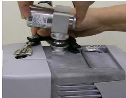
**Abbildung 9 Einbau des Einlassventils in die Pumpe IDP-3**
