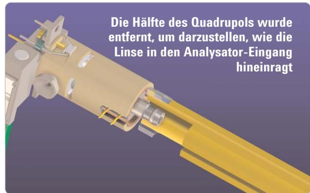
Die letzte Linse, die in den beheizten monolithischen Quadrupol hineinragt, optimiert die Ankopplung der Quelle an den Analysator. Die Spannung der Linse wird dynamisch synchron mit der Analysatorspannung erhöht, um das maximale Ionenignal für jeden m/z-Wert im Zentrum des Quadrupolfelds zu fokussieren.
