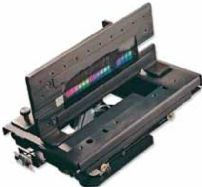
Mithilfe des Zubehörs für den Filmhalter und den motorisierten Probentransport kann das Cary-Spektralphotometer für schnelle Messungen von Blättern, Filmen, Gelen, Wafern oder Mehrfachfiltern angepasst werden
