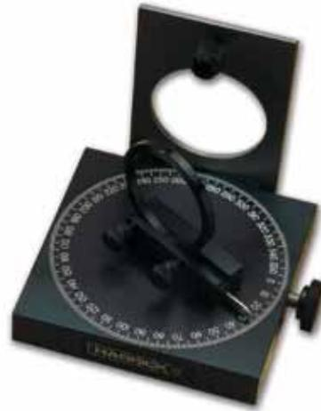
Der Polarisationswinkelhalter misst die Lichttransmission einer festen Probe bei verschiedenen Einfallswinkeln.
