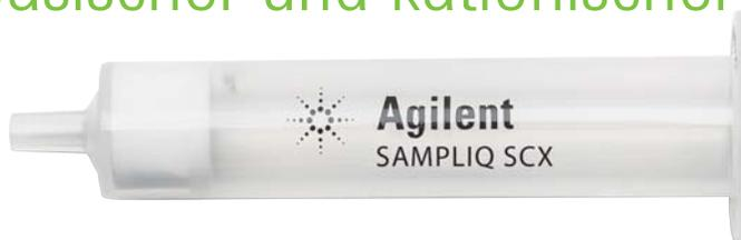
**Das gemischte SampliQ starkes kationenaustauscher SCX Harz (Strong Cation Exchange)** von Agilent ist ein mit Sulfonsäure modifiziertes Divinylbenzol-Polymer mit Ionenaustausch- und Umkehrphasen-Retentionsverhalten. Dadurch zeigt das SampliQ SCX-Harz eine ausgezeichnete Retention sowohl für basische als auch neutrale Verbindungen über einen großen Bereich an Hydrophilie (log P). Zusätzlich ist das Harz inert gegen eine Vielzahl an Lösungsmitteln, mit Wasser benetzbar und von pH 0 -14 stabil.
