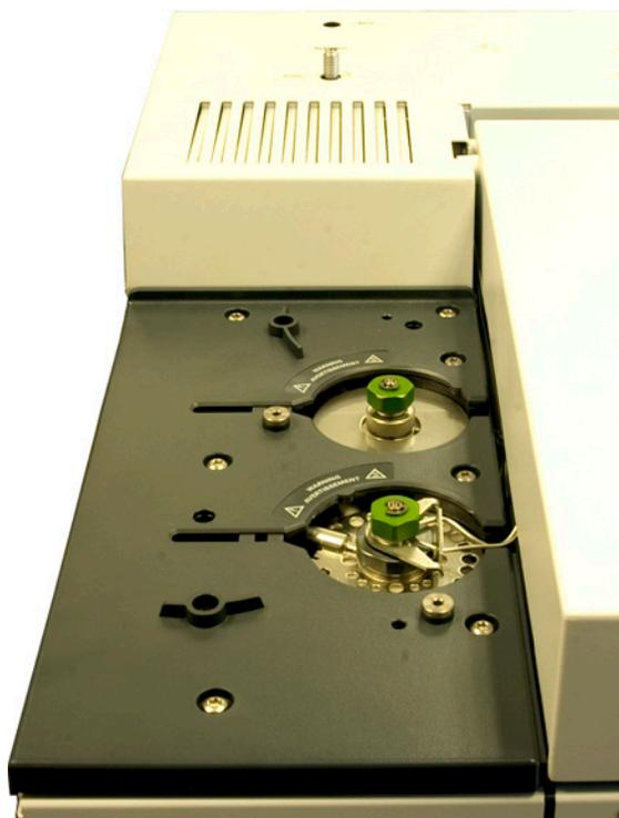
I campioni possono essere introdotti negli iniettori manualmente con una siringa oppure per mezzo di un campionatore automatico (per esempio un campionatore automatico di liquidi Agilent oppure un campionatore per spazio di testa Agilent).
