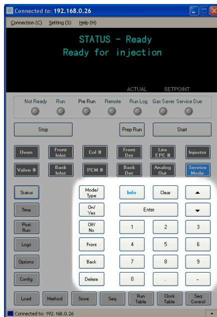
**[Mode/Type]** Accede a un elenco di possibili parametri associati alle impostazioni non numeriche di un componente. Per esempio, se il GC è configurato con un iniettore split/splitless e viene premuto il tasto **[Mode/Type]**, le opzioni elencate saranno split, splitless, split pulsato o splitless pulsato.
