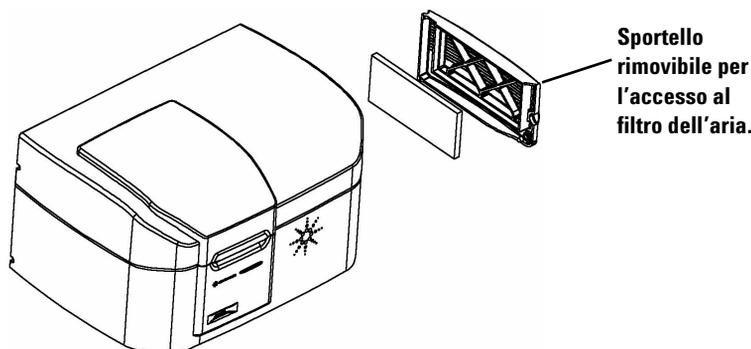
**Figura 34** Apertura e rimozione dello sportello di accesso al filtro dell'aria
