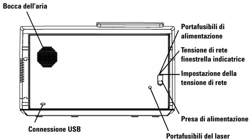
Figura 4 Scanner per microarray, vista posteriore
