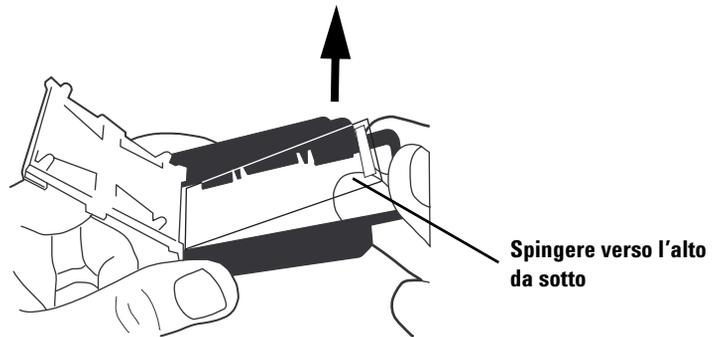
**Figura 19** Rimozione corretta del vetrino
