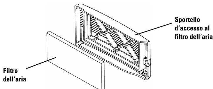
**Figura 35** Rimozione del filtro dell'aria
