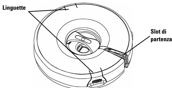
**Figura 17** Copertura del caricatore circolare
