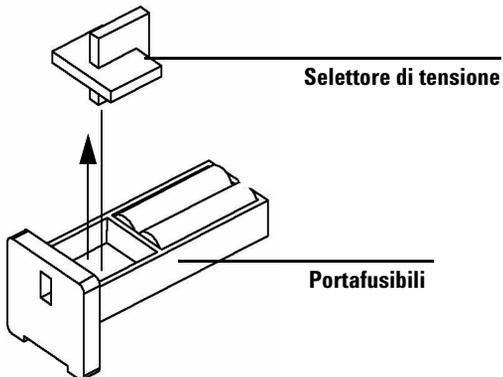
**Figura 45** Rimozione del selettore di tensione dal portafusibili
