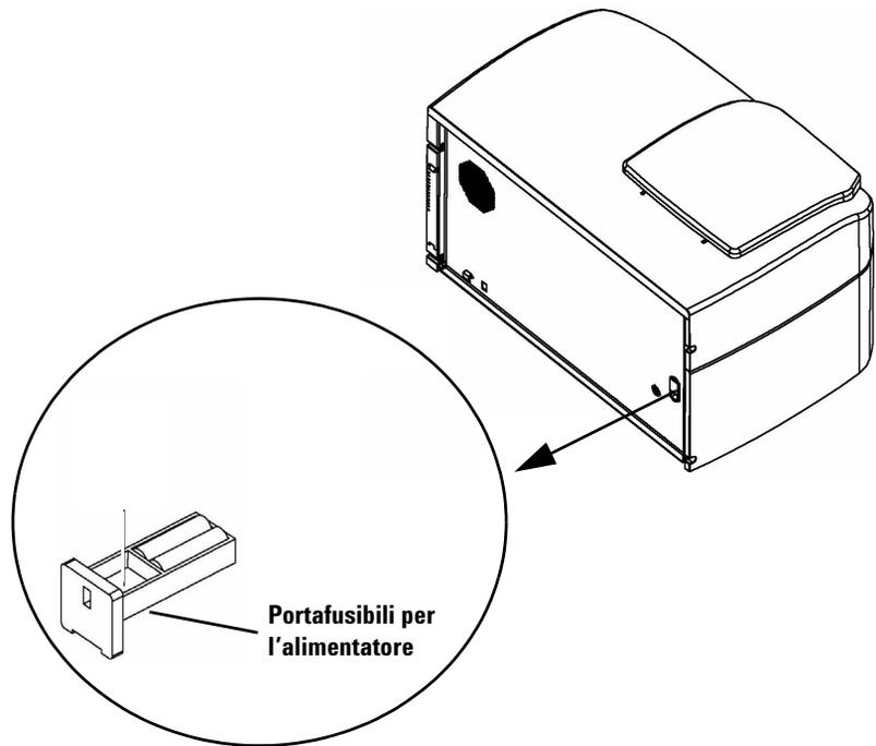
**Figura 37** Estrazione del portafusibili per l'alimentatore
