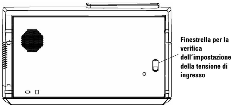
**Figura 43** Finestrella per la verifica dell'impostazione della tensione di ingresso
