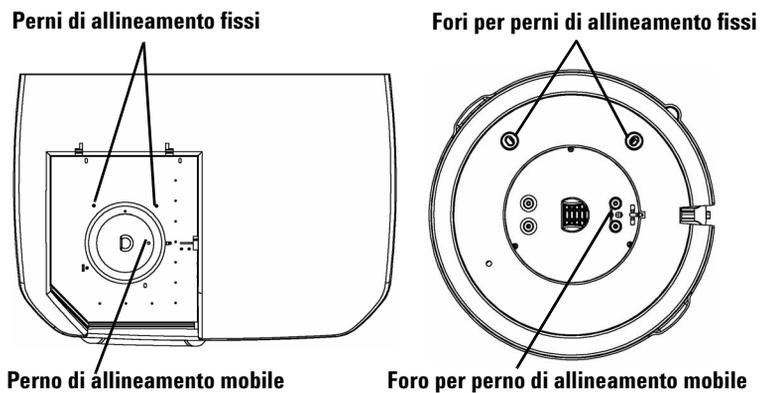
**Figura 18** Allineamento di perni e fori sullo scanner e sul caricatore
