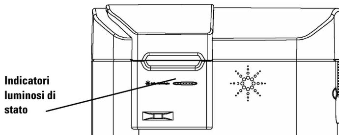
**Figura 36** Posizione degli indicatori luminosi di stato
