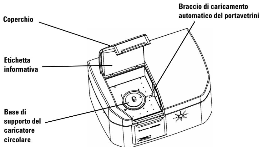
Figura 3 Scanner per microarray, vista dall'alto
