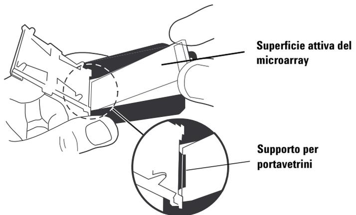
**Figura 10** Posizionamento corretto del vetrino sul supporto
