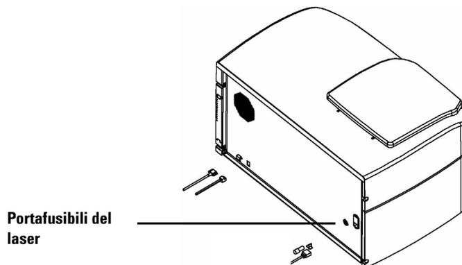
**Figura 38** Portafusibili del laser
