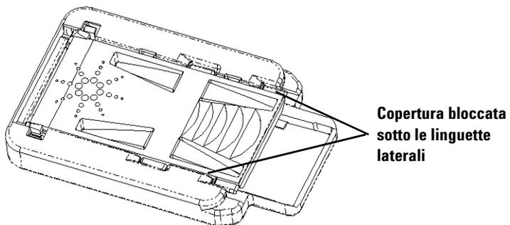
**Figura 15** Copertura bloccata correttamente
