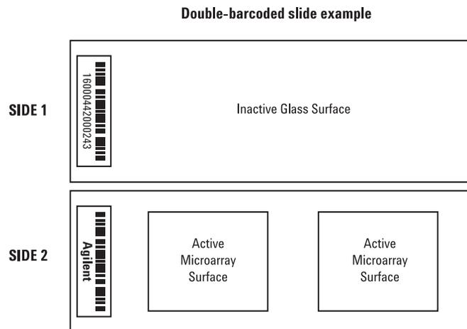
**Figura 41** Orientamento del codice a barre sul vetrino Agilent rispetto alla superficie del microarray
