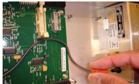
Figure 3 Débranchement de l'alimentation colonne capillaire/chambre de nébulisation de la carte PCA de la vanne (à g.) et du câble de la colonne capillaire/chambre de nébulisation (à d.)
