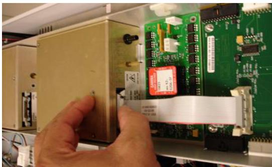
**Figure 5** Connexion de la carte PCA de la vanne et de l'alimentation colonne capillaire/chambre de nébulisation
