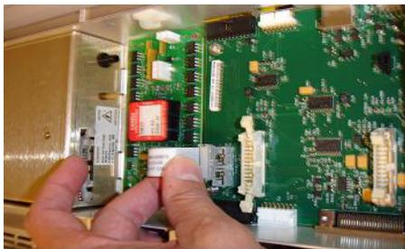
**Figure 4** Connexion de la carte PCA de la vanne et de l'alimentation HT de la source multimodale
