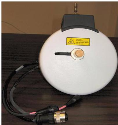
**Figure 15** Chambre de nébulisation de la source multimodale
