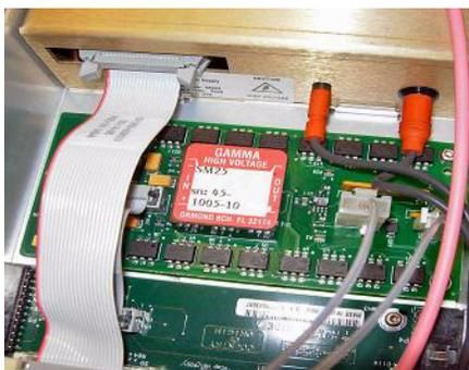
**Figure 6** Branchement des câbles de la colonne capillaire/chambre de nébulisation à l'alimentation
