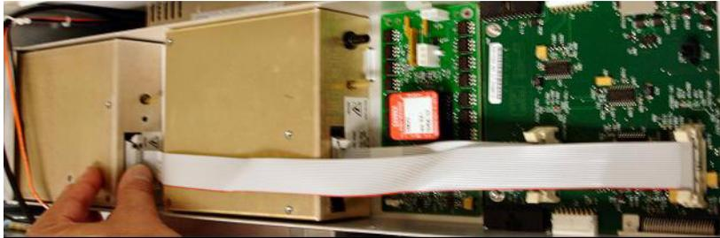
**Figure 7** Connexion de l'alimentation HT APCI à la carte PCA de la vanne.
