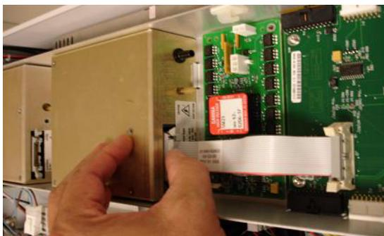
**Figura 5** Collegamento del PCA della valvola all'alimentazione di Vcap/Vchamber.
