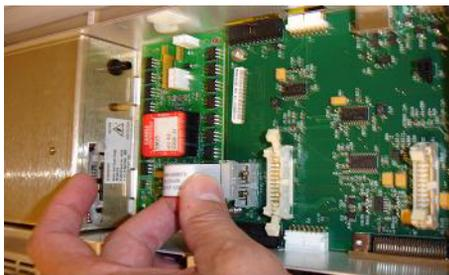
**Figura 4** Collegamento del PCA della valvola all'alimentazione dell'unità HV multimode.
