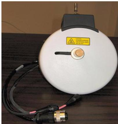
**Figura 15** Camera di nebulizzazione multimode
