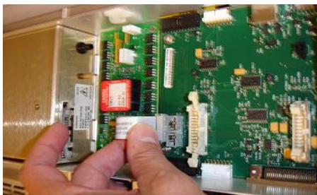
**Abbildung 4** Verbinden der Ventil-PCA mit der Multimode-HV-Stromversorgung.
