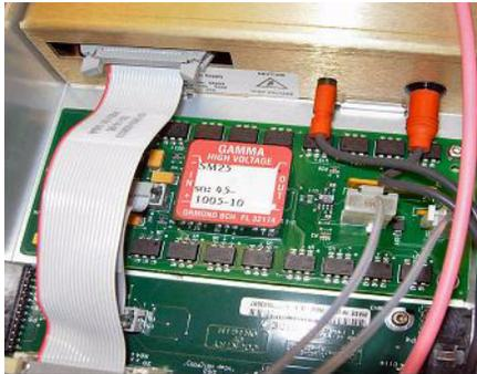
**Abbildung 6** Anschließen der Vcap- und Vchamber-Kabel an die Stromversorgung.
