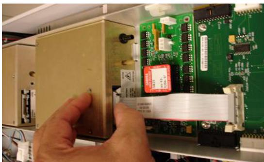
**Abbildung 5** Verbinden der Ventil-PCA mit der Vcap/Vchamber-Stromversorgung.
