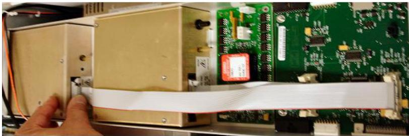
**Abbildung 7** Verbinden der APCI HV-Stromversorgung mit der Ventil-PCA.
