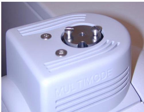
**Abbildung 17** Kein Zerstäuber auf der Multimode-Ionenquelle
