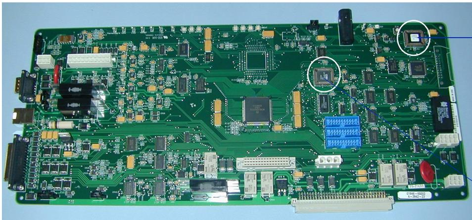
**Circuit imprimé de la mémoire ROM MM LON programmée installé dans le logement U6 (nouvelle référence G1978-80100)**
