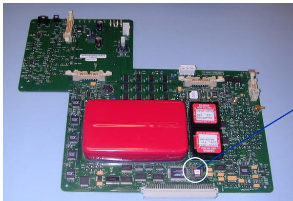
Remplacement du circuit imprimé de microprogramme PLCC principal par la référence G1978-80067 sur la carte d'analyseur (logement U129)
