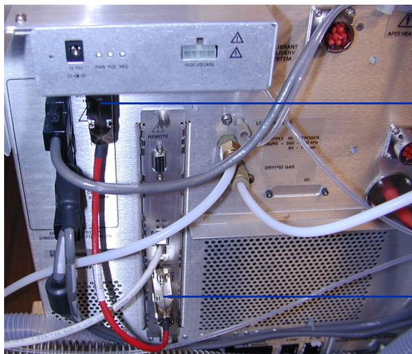
Branchement RS-232 à la carte PCA de contrôle et au module HT
