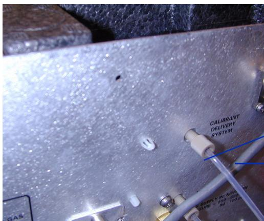
Ligne de gaz du système de distribution de solution étalon
