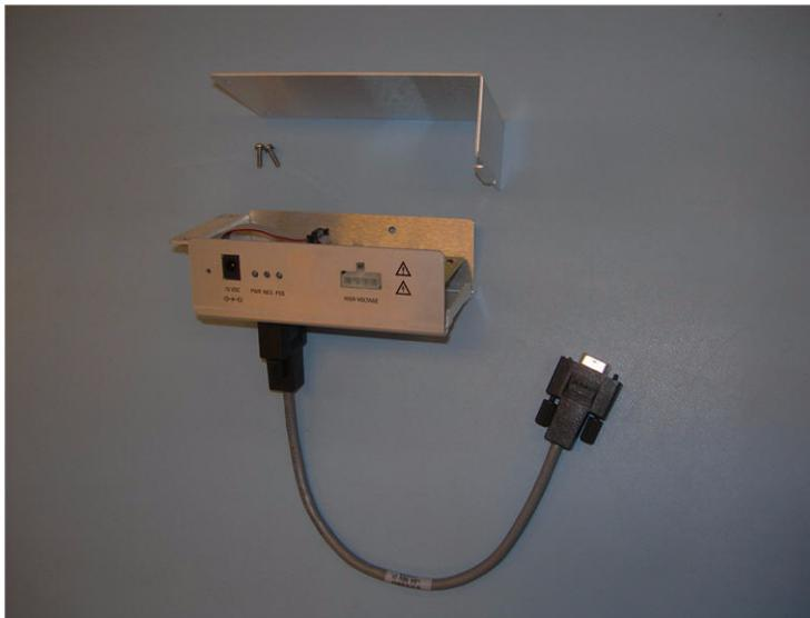
**Figura 14** Collegamento del cavo RS-232
