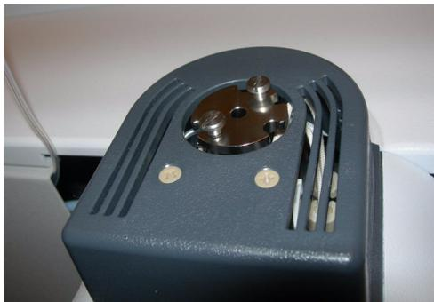
**Figura 10** Sorgente multimode senza nebulizzatore
