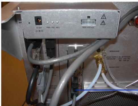
Porta COM 2 del sistema processore GEPS
