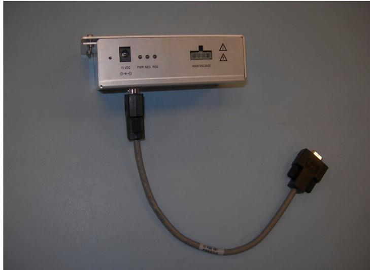
**Figura 13** Coperchio HV e dell'alimentatore PCA di controllo della sorgente rimosso
