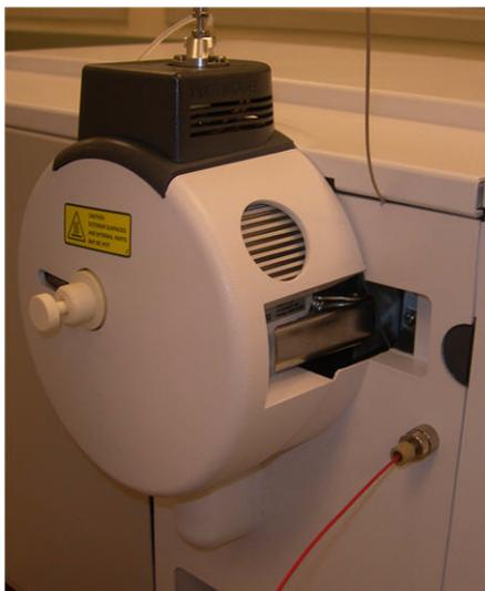
**Figura 12** Tubo campioni LC/MS della trappola ionica collegato al filtro in ingresso
