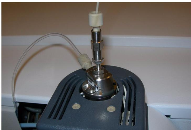
**Figura 11** Nebulizzatore con tubo del gas collegato
