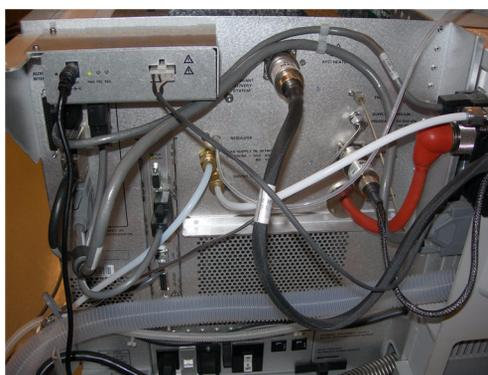
**Figura 22** Collegamenti dei cavi della sorgente multimode
