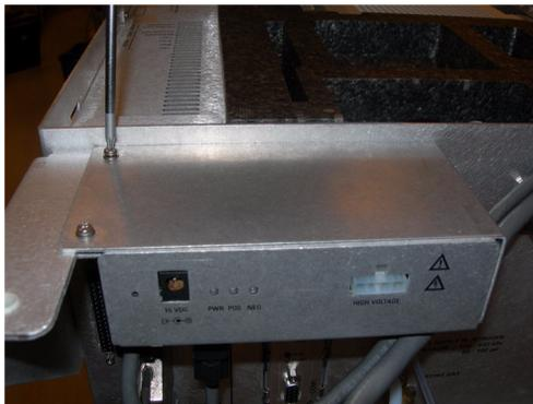
**Figura 18** Fissaggio alle staffe di supporto
