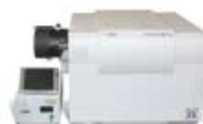
MSD Trap Agilent série 1100 avec source AP-MALDI
