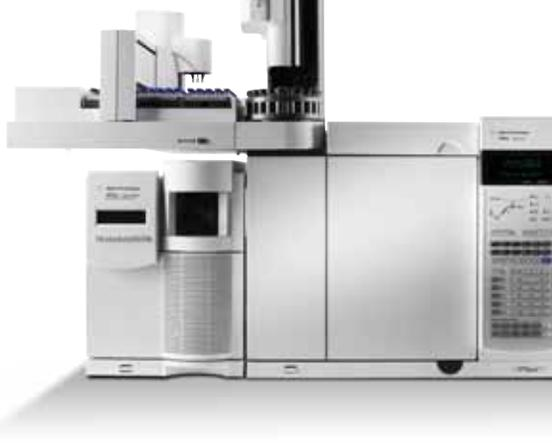
*Le système GC/MSD Agilent série 5975C associe des fonctionnalités matérielles et logicielles innovantes, pour des performances optimisées de l'injection au rapport final. Il vous permet également de bénéficier de limites de détection et de quantification exceptionnellement basses.*
