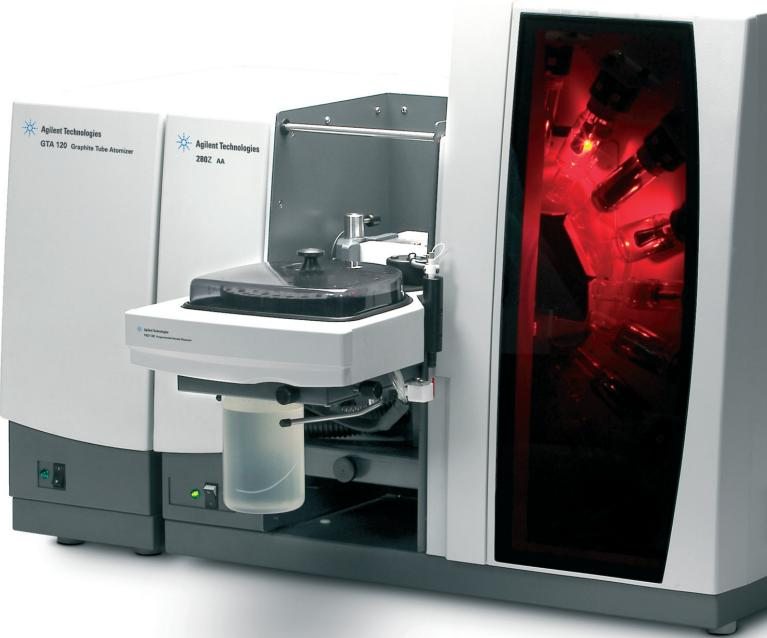
*Les systèmes Zeeman d'Agilent utilisent les interpolations polynomiales à 3 points pour suivre avec précision le signal de fond, ce qui multiplie par 11 la précision de la correction obtenue.*
