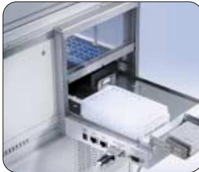
Le lecteur de code-barre fixe monté sur l'interface d'automatisation série 1100 est utilisé pour l'identification positive automatisée des plaques pendant l'exécution des hyperséquences.
