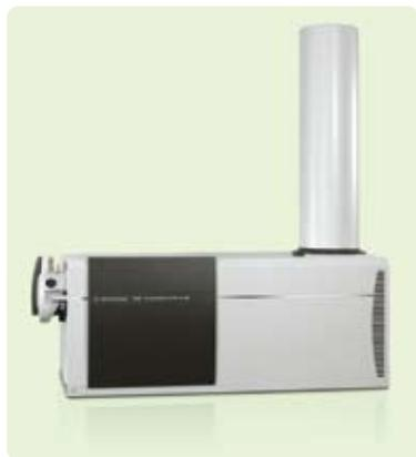
*Avec l'ajout de la technique de focalisation par gradient thermique Agilent Jet Stream, le nouveau système 6530 devient le Q-TOF le plus sensible au monde. Utilisant une technique TOF vraiment haute résolution, le système fournit une précision en masse incomparable – 1 à 2 ppm en SM et 2 à 4 ppm en SM/SM – qui permet de lever les ambiguïtés dans l'élucidation de structures et l'identification de composés cible.*
