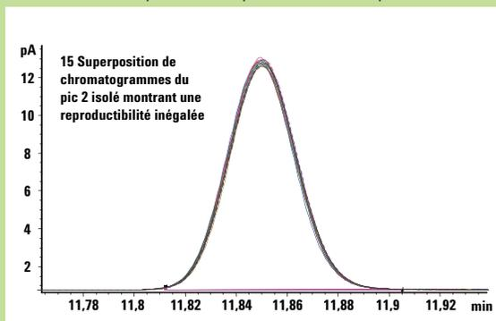
La reproductibilité des temps de rétention est inégale, non seulement dans les applications standard, mais aussi en chromatographie multidimensionnelle comme ci-dessus dans un exemple d'isolement d'un pic.
