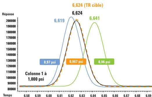
L'EPC de 5ème génération et l'électronique numérique de pointe établissent de nouveaux records de précision de la consigne de pression (jusqu'à 0,001 psi) et augmentent la précision du verrouillage des temps de rétention pour les applications à très faible pression.
