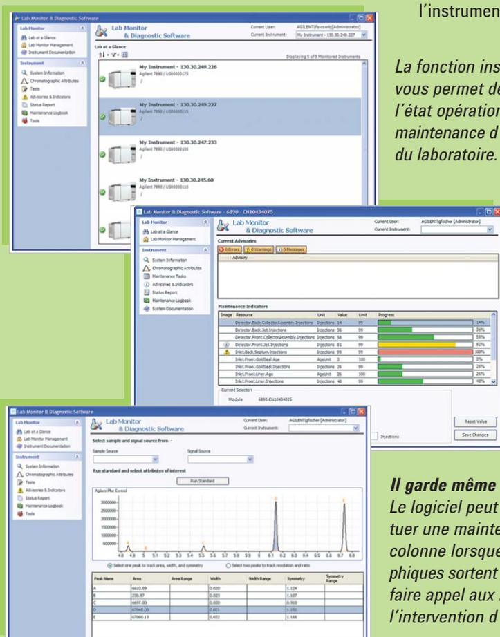
*La fonction instantanée **Lab-at-a-Glance** vous permet de juger d'un coup d'œil de l'état opérationnel et des besoins de maintenance d'un ou plusieurs systèmes de laboratoire.*
