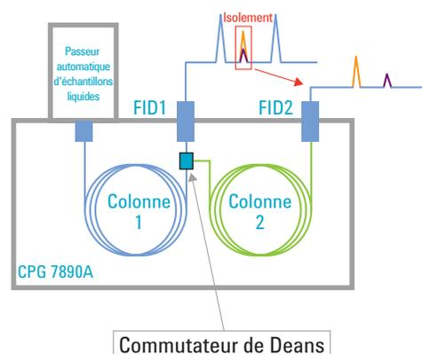
Dans cet exemple, le commutateur de débit capillaire de Deans procure une sélectivité complémentaire qui permet l'analyse de traces non résolues en isolant un pic que l'on analyse sur une autre colonne de phase stationnaire différente.
