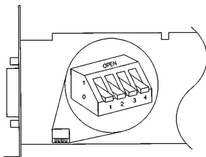
**Figure 5** Réglage des commutateurs DIP de la carte d'interface GPIB 82341
