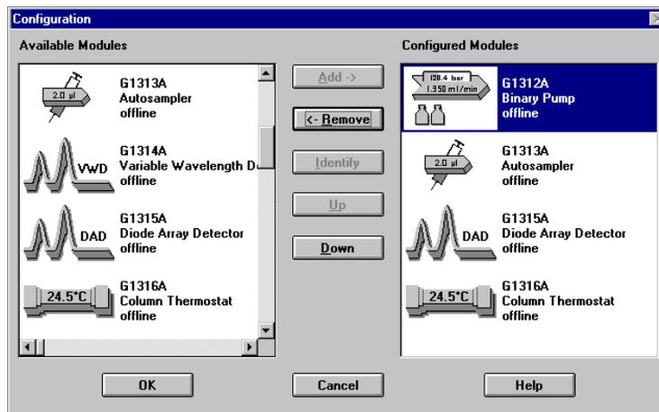
**Figure 19** La boîte de dialogue "Configure Agilent 1100 System Access" permet d'inclure dans votre configuration les modules Agilent 1100 détectés dont vous avez besoin.
