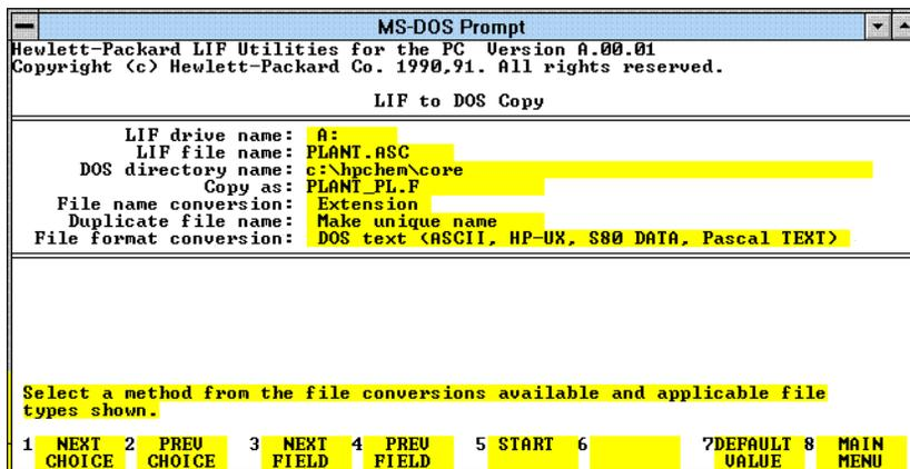
**Figure 27** Réalisation d'une copie d'un fichier . PLF sous DOS à l'aide de l'utilitaire LIF
