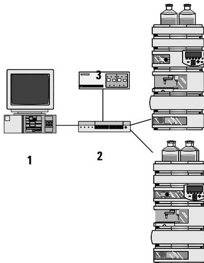
**Figure 12** Connexion à un réseau local par l'intermédiaire d'un concentrateur
