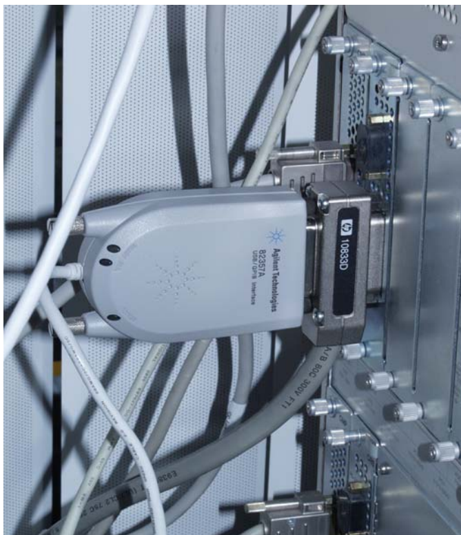
Figure 22 Interface USB-GPIB 82357A sur par exemple un HP 1090/DAD
