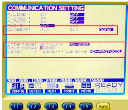
**Abbildung 23** Bildschirmanzeige „Communication Setting“ (Anschlusseinstellungen)
