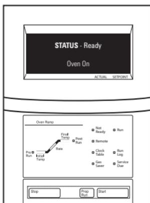
Schalten Sie den GC ein. Überprüfungsmethode für den verwendeten Einlass und Detektor laden. Warten Sie, bis auf dem Anzeigebildschirm „Ready“ angezeigt wird.
