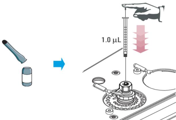
Bei einer **manuellen Injektion**: Überprüfungprobe vorbereiten. Probe in Einlass injizieren und Starttaste drücken.
