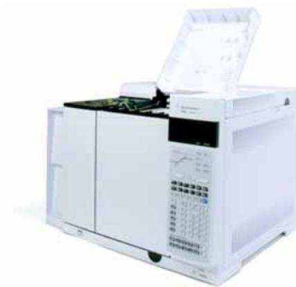
GC auf dem Arbeitstisch platzieren und Detektorkappen unter der Detektorabdeckung entfernen.
