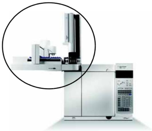
Probengeber und Teller installieren und die Kabel an der Rückseite anschließen.
