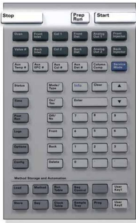
**[Stop]** Beendet die Analyse umgehend. Wenn der GC gerade eine Analyse ausführt, gehen die Daten dieser Analyse möglicherweise verloren. Informationen zum erneuten Start nach Betätigung der Taste **[Stop]** finden Sie im [Erweiterten Agilent 7890A GC Benutzerhandbuch](#).
