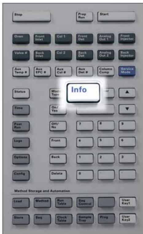
**[Info]** Bietet kontextbezogene Hilfe für aktuell angezeigte Parameter. Wenn z. B. **Oven Temp** (Ofentemperatur) die aktive Zeile der Anzeige ist (gefolgt von <), zeigt **[Info]** den gültigen Bereich für Ofentemperaturen an. In anderen Fällen zeigt **[Info]** Definitionen oder Aktionen an, die ausgeführt werden müssen.
