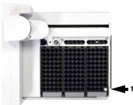
Für **Injektionen mit automatischem Probengeber:** Überprüfungsprobenfläschchen vorbereiten. Probe in Probengeber laden und Starttaste drücken.
