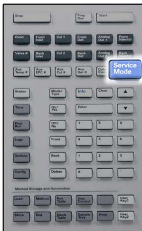
**[Service Mode]** Se utiliza para acceder a la configuración y funciones de mantenimiento, contadores de servicio y diagnósticos del GC.
