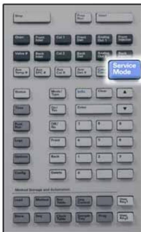
**[Service Mode]** Cette touche permet d'accéder aux réglages et aux fonctions de maintenance, aux compteurs d'entretien et au diagnostic du CPG.
