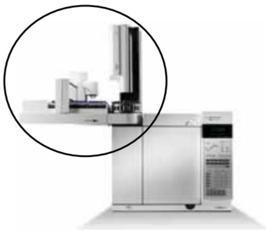
Mettez le passeur d'échantillons et le plateau en place et branchez les câbles sur le panneau arrière.
