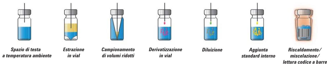
**Flessibilità di campionamento estesa e nuove opzioni di automazione.** Profondità variabili dell'ago consentono di prelevare il campione in qualsiasi punto del vial. Nuove funzioni opzionali di gestione del campione consentono di aumentare ulteriormente la produttività del tuo laboratorio.
