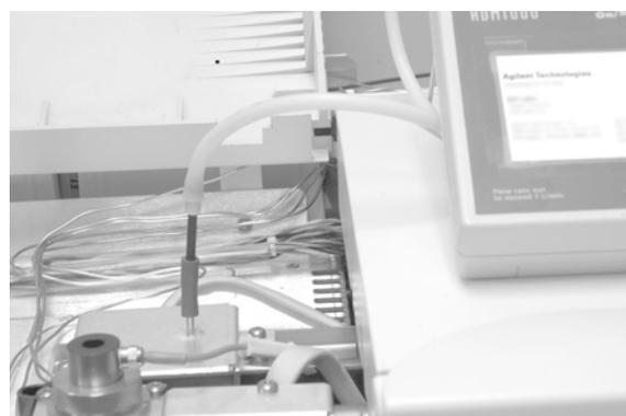
8 流量計アダプタに流量計を取り付けて、流量を測定します。
