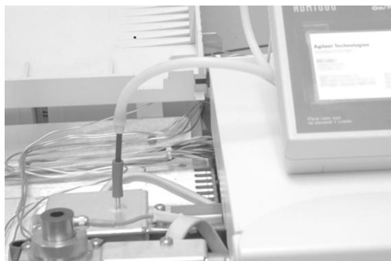
7 流量計アダプタに流量計を取り付けて、流量を測定します。
