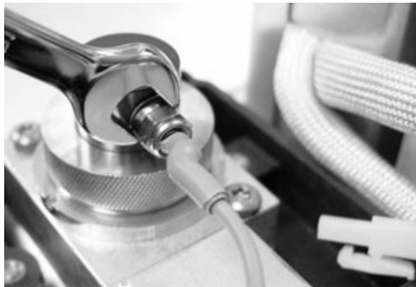
**c** Tournez l'écrou à la main dans le sens inverse des aiguilles d'une montre. Retirez le briquet d'allumage et la rondelle ressort.
