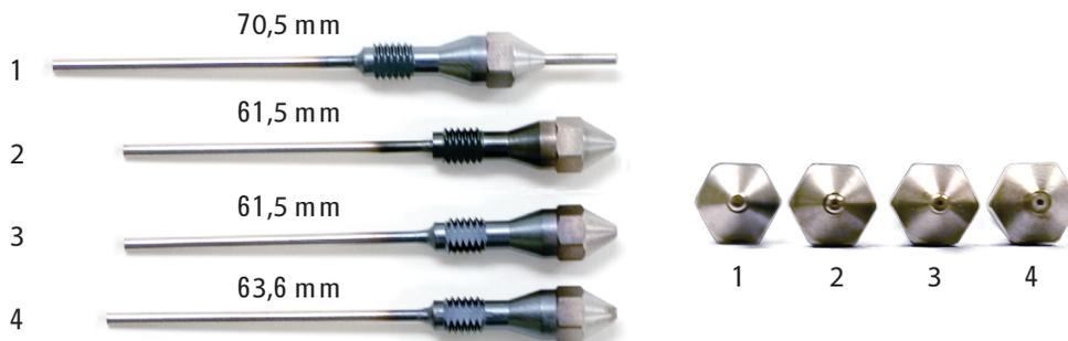
**Figure 4** Buses pour NPD adaptable
