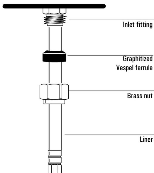
**Figure 27. Installing a liner**
