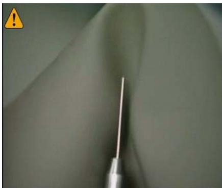
図 20 ニードル先端に沿って研磨紙を引っぱりよじらせる
