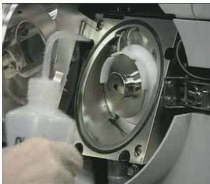
図 4 スプレーシールドの周りの部位を洗浄する
