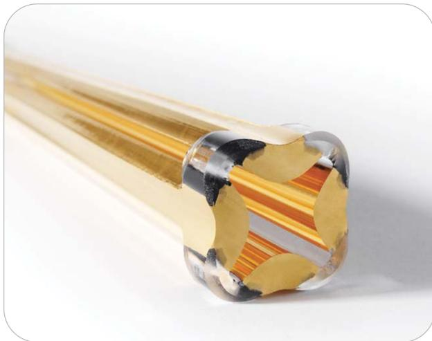
Die genau hyperbolische Quarzstruktur hat eine sehr geringe thermische Ausdehnung und bietet dadurch eine hervorragende Maßbeständigkeit. Das einzigartige Design verursacht weniger Fehler im Vergleich zu runden Quadrupolen im elektrischen Feld wie auch eine hervorragende Auflösung und Massenachsenstabilität, und dies unabhängig von Temperaturänderungen im Labor.
