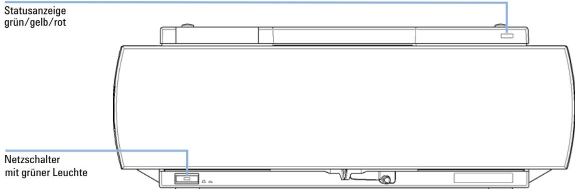
**Abbildung 19** Vorderansicht des Säulenthmostats
