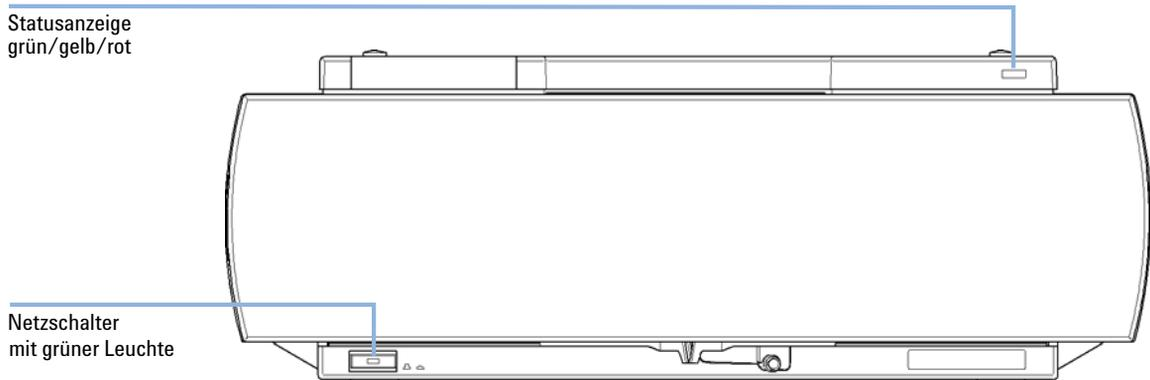
Abbildung 28 Position der Statusanzeigen
