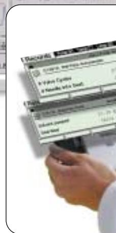
Tanto el dispositivo de control manual como la ChemStation muestran el volumen de disolvente bombeado, el tiempo de uso de la lámpara y el número de inyecciones. También presentan mensajes de alerta cuando se exceden los límites predeterminados, facilitando así un puntual mantenimiento.
