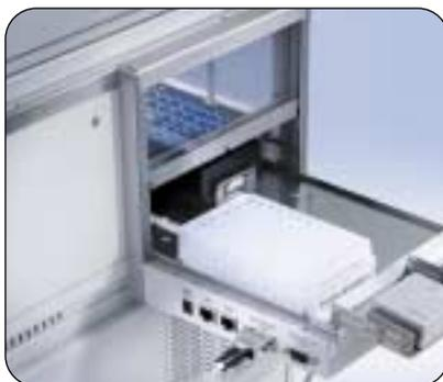
El lector de códigos de barras estacionario, montado en la interfase de automatización Serie 1100, se utiliza para la identificación positiva automatizada de las placas durante la ejecución de un análisis de hipersecuencia.
