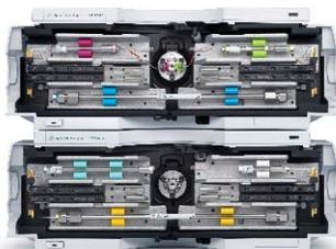
Utilizzando due comparti colonne termostatati e valvole di selezione, è possibile combinare fino a otto colonne di lunghezza massima pari a 100 mm oppure sei colonne con un condotto di scarico e un bypass. Aggiungendo un terzo comparto, è possibile anche utilizzare colonne di lunghezza superiore a 100 mm.
