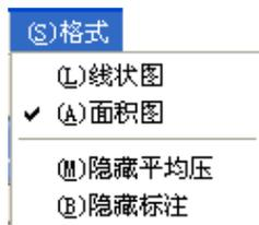
**面积图：**挑选这个选项以后，DynaPulse 软件将趋势曲线下方填入对应颜色（收缩压用红色，平均压用黄色，舒张压用蓝色，心率用绿色）。面积图是默认的图形风格，包括所有的分析图形和趋势图。
