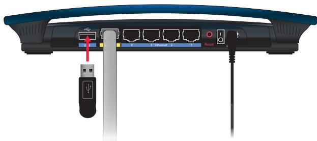
Wenn ein USB-Laufwerk an den USB-Port des Routers angeschlossen ist, wird automatisch ein freigegebener Ordner namens **public** (öffentlich) erstellt und auf dem USB-Laufwerk freigegeben. Sie können über Windows Explorer oder den Mac Finder auf die Inhalte zugreifen. Weitere Einzelheiten zum Zugreifen auf die Inhalte finden Sie unter Installation und Zugriff auf USB-Speichergeräte – **„Übersicht“** auf Seite 38.
