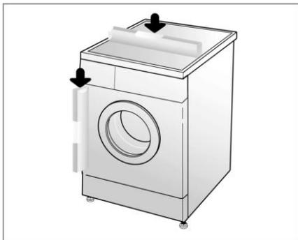
1. 调整洗衣机水平,可以防止额外的噪音和振动。将机器安装在结实且水平的地面上,最好在房间的角落。
