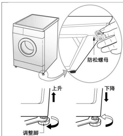
2. 如果地面不水平,就必须调整调整脚(不要在脚下塞入木片等物体来调整),确定四个脚稳定地接触地面,且检查机器完全水平。(使用水平仪)
