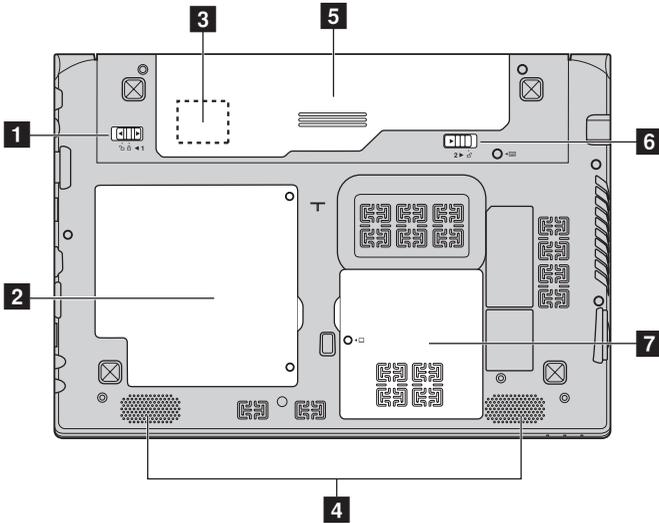
**1** 电池锁扣 - 手动式 手动式电池锁扣可固定电池模组。
