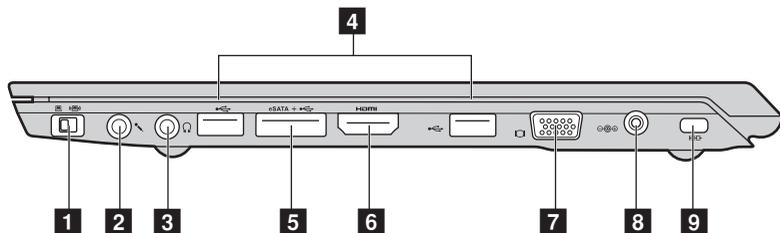
**1 内置无线设备开关** 使用此开关打开 / 关闭您电脑上的所有无线设备的无线功能。
