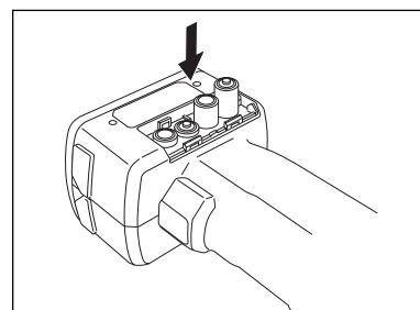
4 将电池盖的凹槽与电池槽开口边缘的导向装置对齐。
