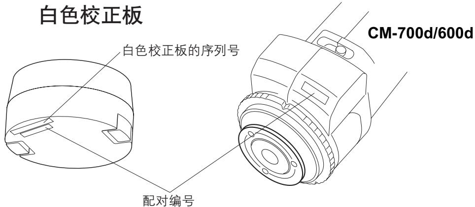
配套使用的仪器和白色校正板必须具有相同的配对编号。
