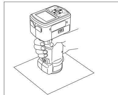
4 确认 (测量准备就绪) 图标显示在屏幕上，或者就绪灯 (Ready) 变成绿色，然后按下测量按钮。
