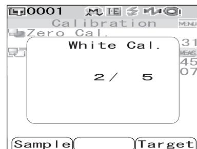
零校正完成后，屏幕返回 <Calibration> (校正) 界面。
