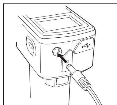
**4** 将交流适配器的电源插头插入交流电源插座中 (100~240 VAC, 50~60 Hz)。
