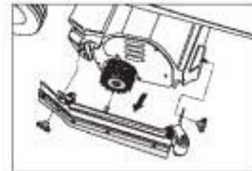
■拆卸下滚刷，插入新的滚刷（注意滚刷六角形的定位器）
