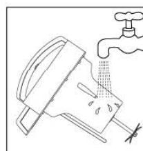
1. 机头：请用水轻轻洗去机头下部粘附的豆浆或其它残留，切勿将机头浸入水中，也不要用水清洗机头上部，以防机头进水，发生短路现象。
