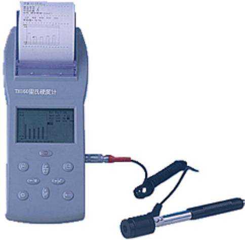
**产品概述:** 里氏硬度计是一种新型的便携式硬度测试仪器,主要适用于测试金属材料的硬度,具有测试精度高、体积小、操作容易、携带方便,测量范围宽的特点,它是以里氏硬度为原理,测出里氏(HL)硬度值经过程序自动转换成布氏,洛氏,维氏,肖氏等硬度值,还可以配置各种测试配件,来满足于各种测试条件和环境,主要适用于金属材料的快速硬度测试,特别适宜对大型零部件及不可拆卸部件的现场硬度测试。
