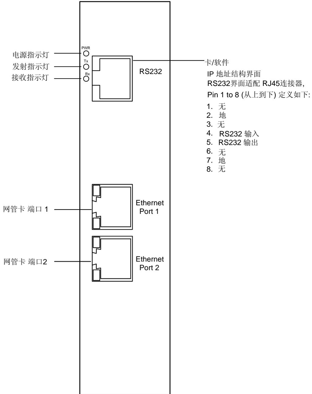
网管卡应插入 18 槽网管大机箱，网管卡的以太网端口和 RS232 端口 分别与上位机的 RJ45 and DB9 端口相连。
