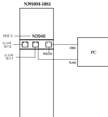
如果多个网管卡一起使用，可用以太网端口 1 和以太网端口 2 来级联下一个网管卡，这两个端口亦可用于连接上位机的 RJ45 端口，另只需把相应网管卡的 RS232 端口接入上位机的 DB9 端口，则可监管相应光端机工作状态。
