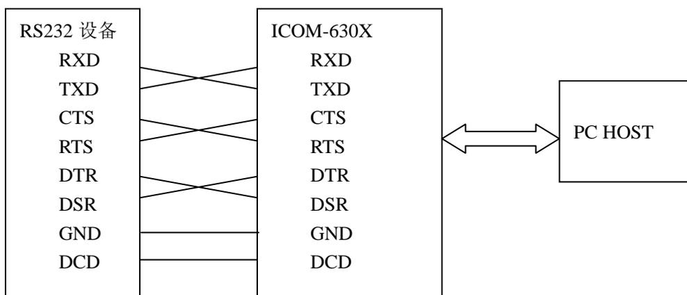
图 4 设备连接示意图
