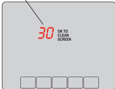
Appuyez sur **SCREEN** pour verrouiller l'écran afin de le nettoyer. L'écran restera verrouillé pendant 30 secondes pour permettre de le nettoyer sans modifier les réglages.
